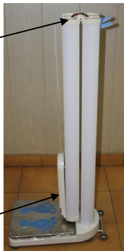
Рис1. Грузовая платформа с основной стойкой в сборе в сложенном состоянии.
